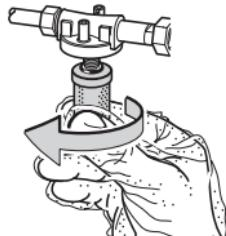
Fatta den nya filterpatronen i den övre plastdelen och skruva in den **för hand** (max. 1,5 Nm).
